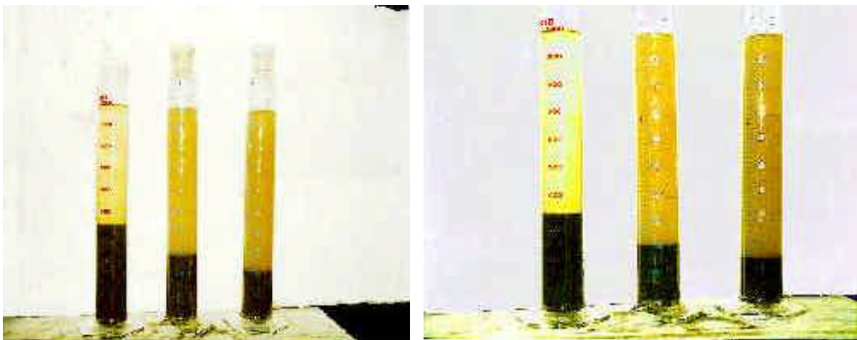
Abb. 2: Sedimentationsverhalten von Überschussschlammproben nach 10 (links) und 30 Minuten (rechts) Absetzzeit, jeweils v. l. n. r.: unbehandelt, geringerer Energieeintrag, höherer Energieeintrag.
